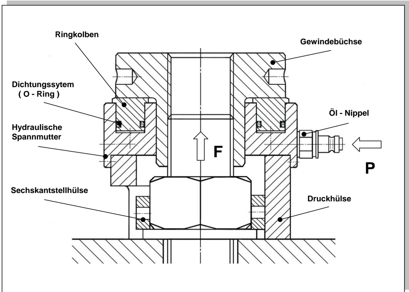
Die Vorspannvorrichtung findet ihren Einsatz bei Schrauben die torsionsfrei und reibungsfrei bis an die Streckgrenze vorgespannt werden.
